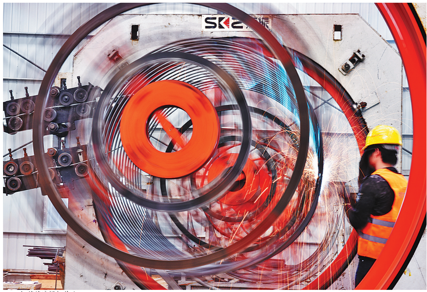
钢筋笼滚焊机作业。
