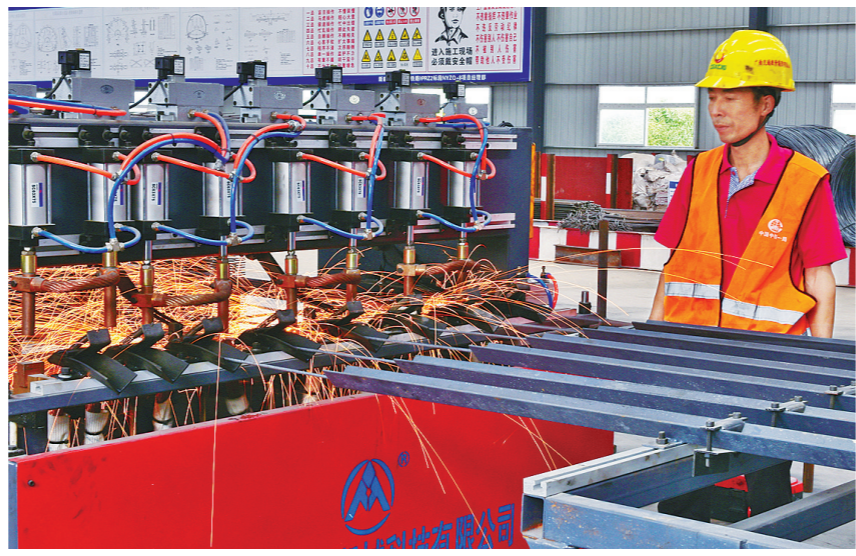
机械制作钢筋网片。
